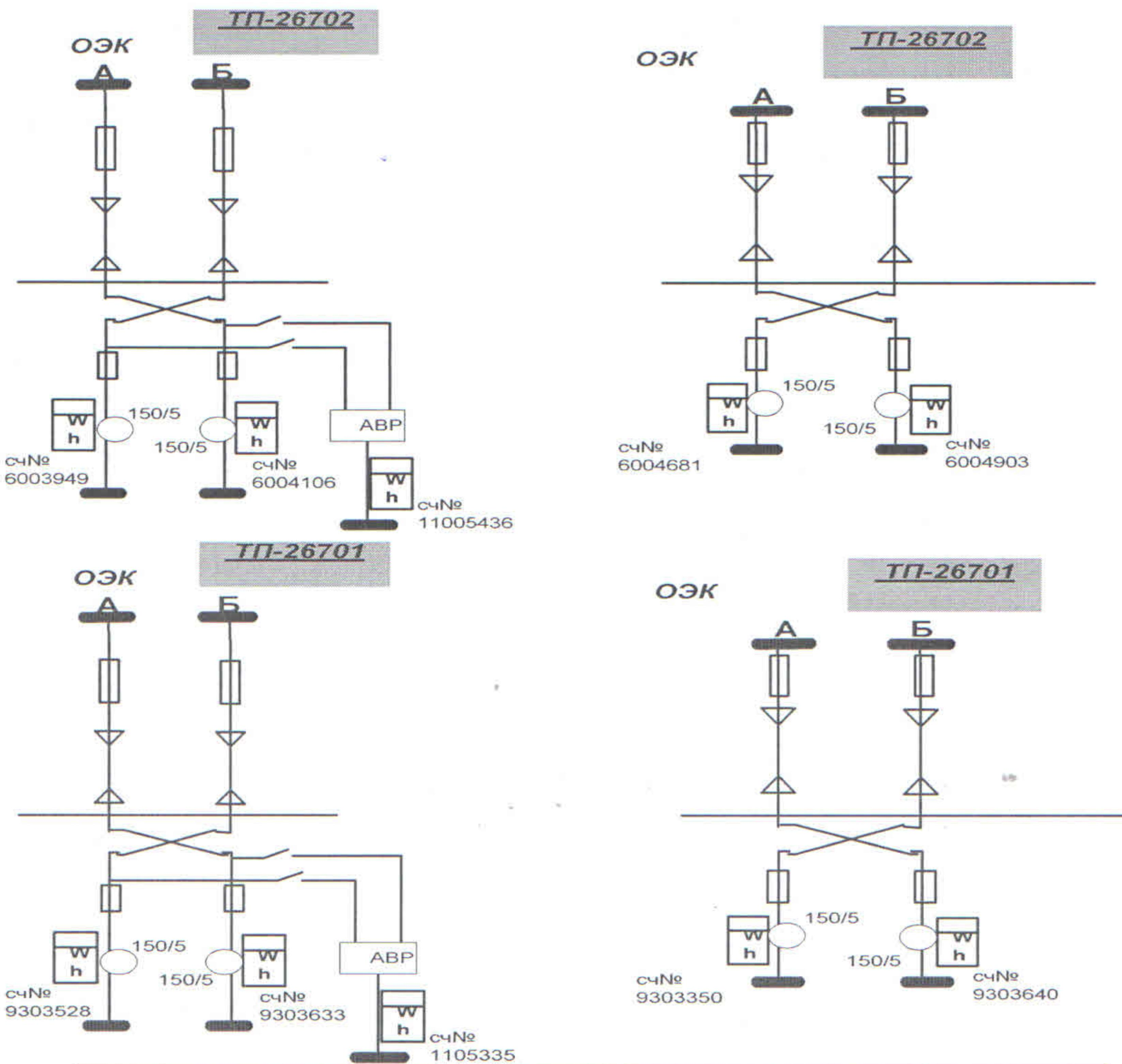
**Примечание:** в схеме указываются места установки и номера приборов учета, параметры измерительных трансформаторов тока и напряжения, границы балансовой принадлежности (красный цвет) и эксплуатационной ответственности (синий цвет), границы с субабонентами/транзитными потребителями (зеленый цвет), длина и марка питающих кабелей (проводов).
