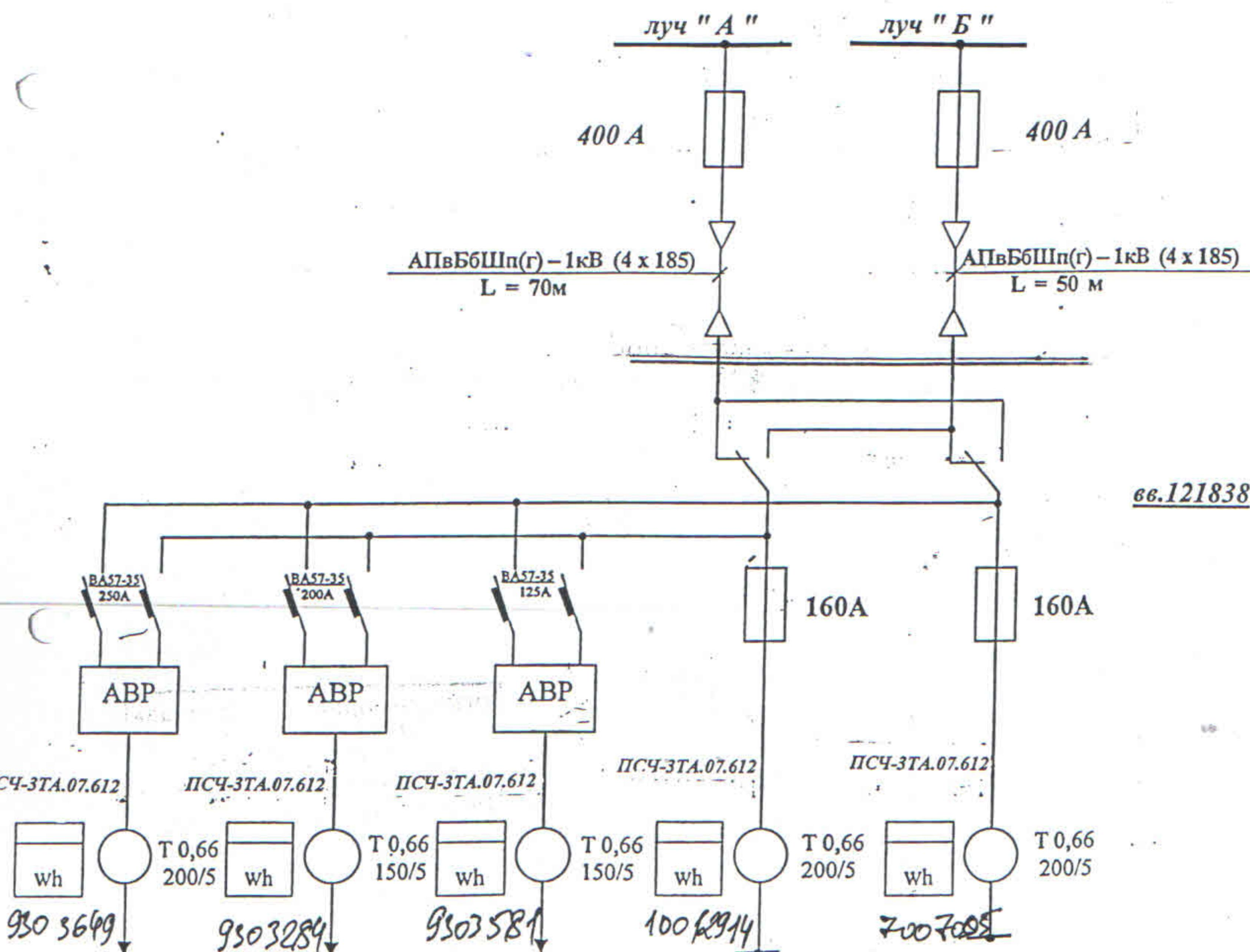
Примечание: в схеме указываются места установки и номера приборов учета, параметры измерительных трансформаторов тока и напряжения, границы балансовой принадлежности (красный цвет) и эксплуатационной ответственности (синий цвет), границы с субабонентами/транзитными потребителями (зеленый цвет), длина и марка питающих кабелей (проводов).
